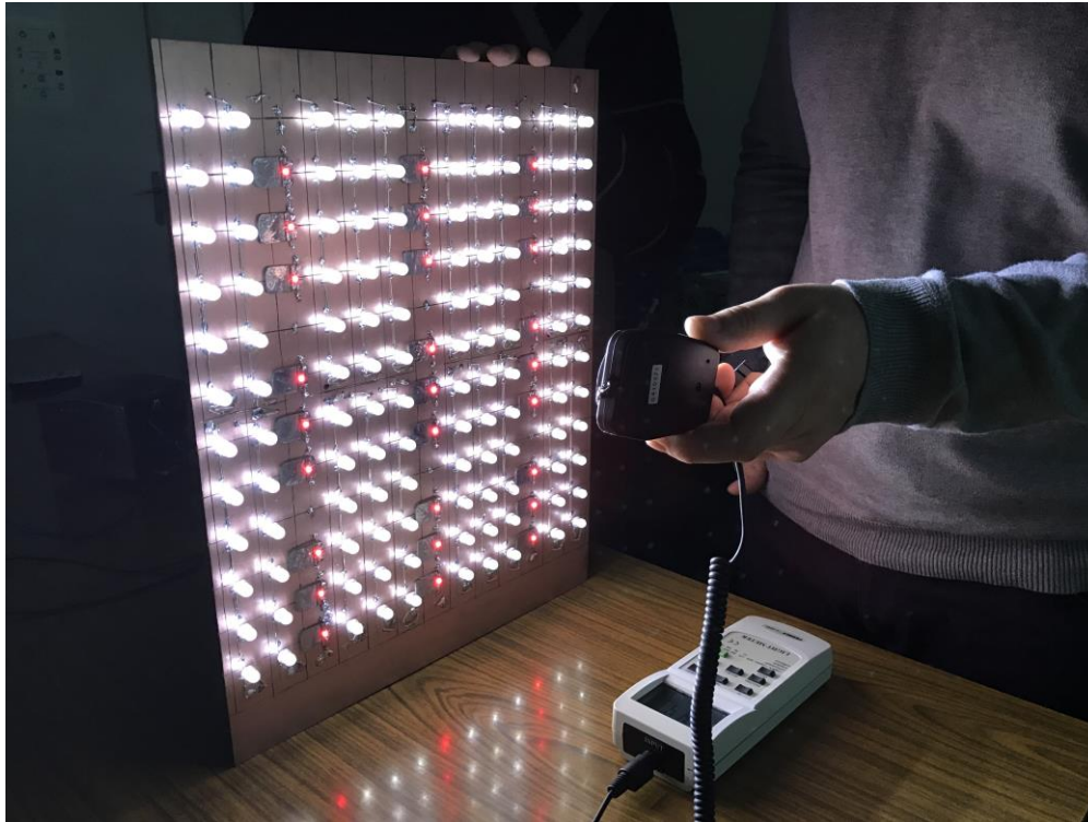
Fig 7.7 Măsurarea intensității luminoase a panoului cu led-uri
